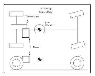
FIGURE 14: SPRUNG MOTOR PMOI AND COG
