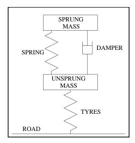
FIGURE 12: MOTOR VEHICLE SPRUNG/UNSPRUNG MASS
