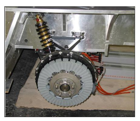
FIGURE 37: WHEEL MOTOR (HYBRIDAUTO.PTY.LTD, 2006)
