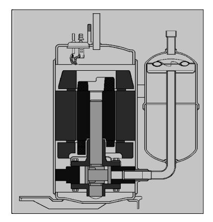
FIGURE 18: SECTION VIEW OF A ROTARY COMPRESSOR(MATSUSHITA-ELECTRIC-JAPAN, 2008)
