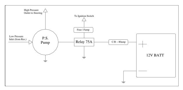
FIGURE 30: POWER STEERING-ELECTRICAL CIRCUIT
