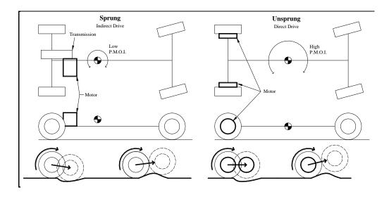
FIGURE 16: FBD SPRUNG UNSPRUNG MOTOR LOCATIONS
