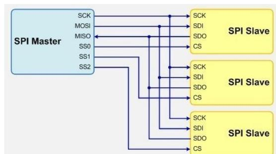
Figure 4.11: SPI protocol wiring diagram. [28].
